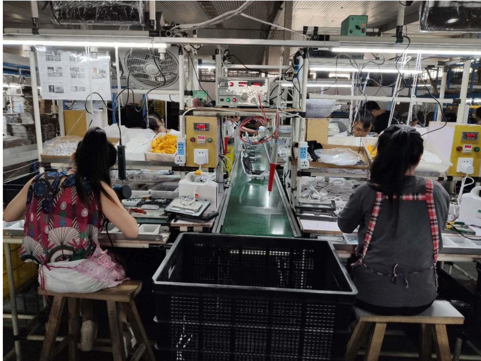
一人完结型CELL 组装+烧机+测热高压1×6人
