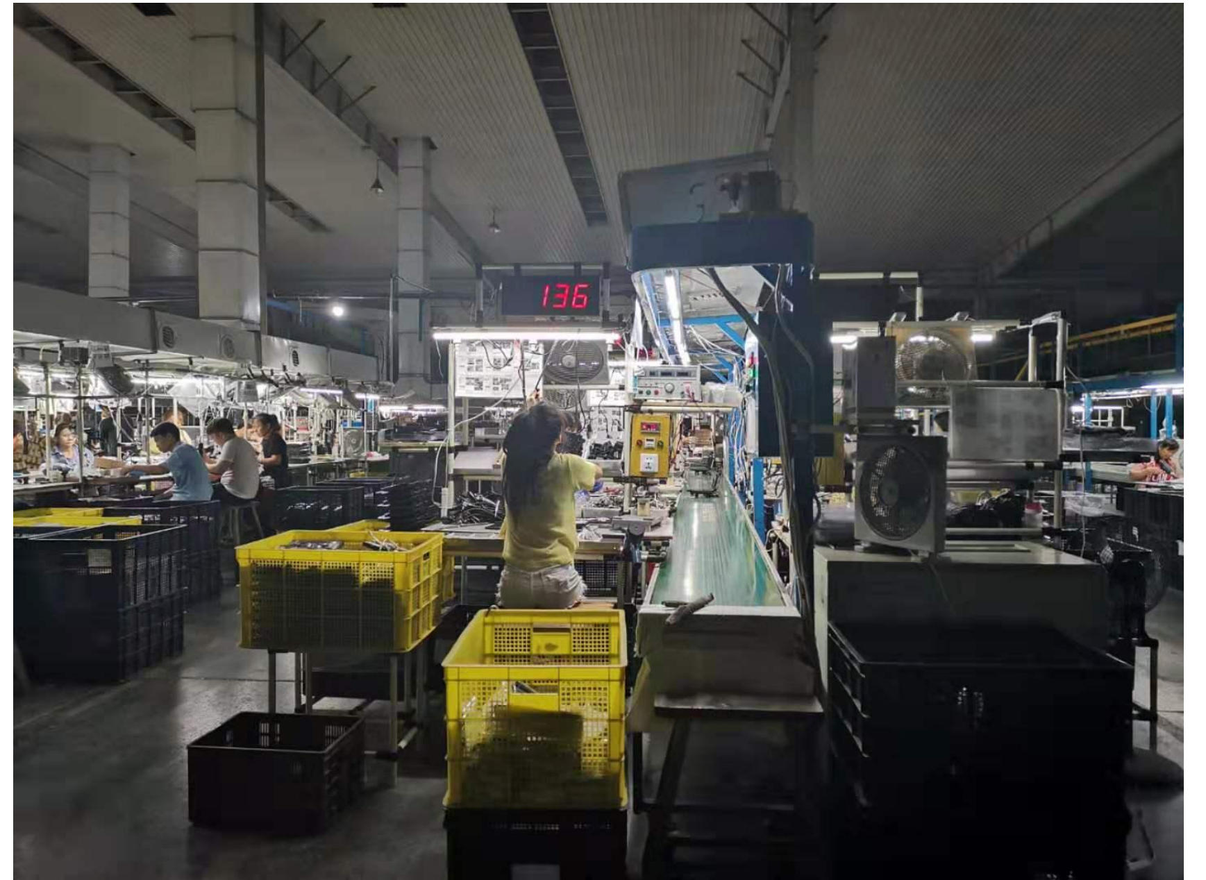
装配一人完结型CELL生产线（组装+烧机+测热高压1×6人）
