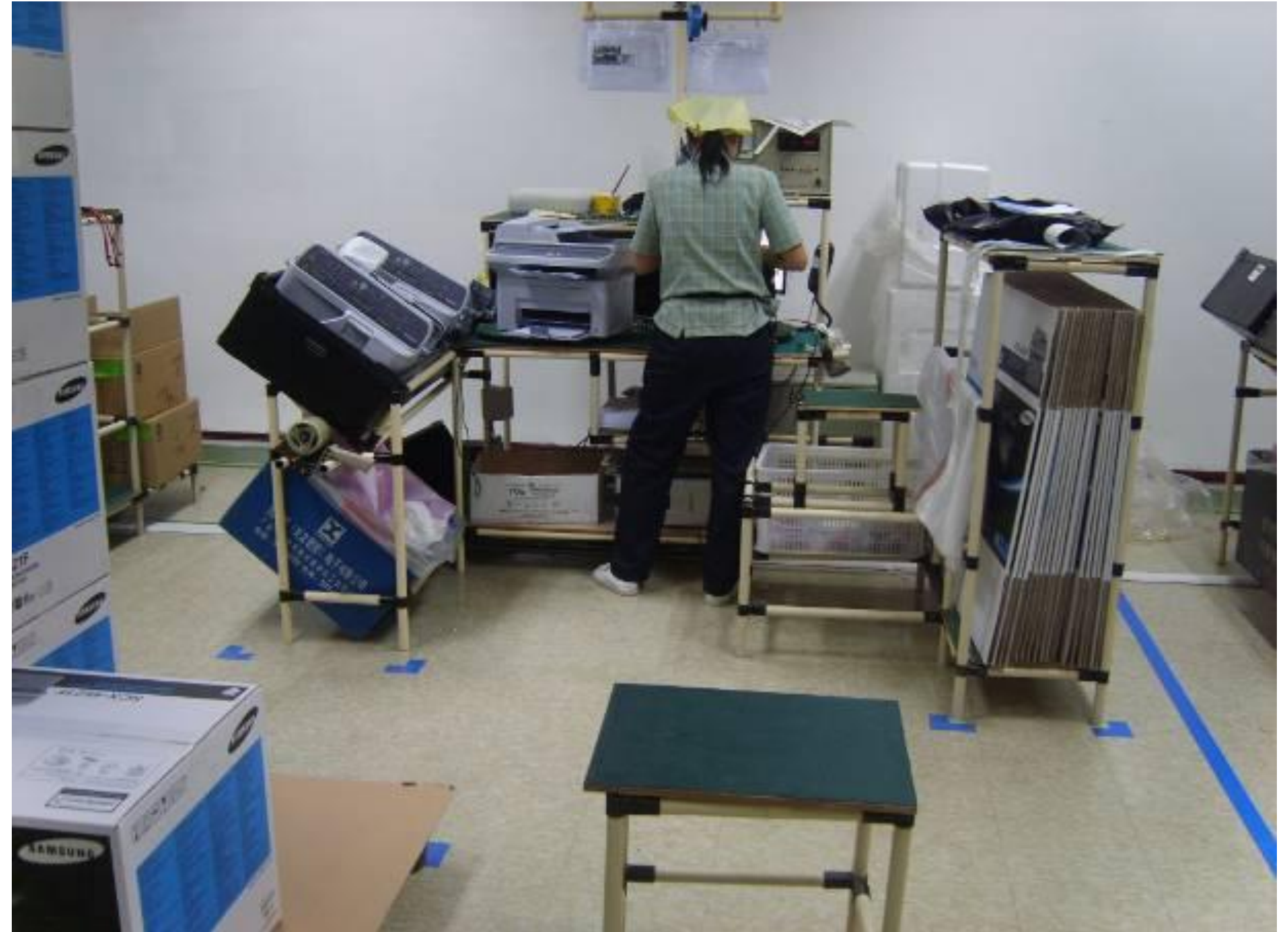
图2 “组装→测试→包装”全部工序全部由一个人完成的单人制作业
