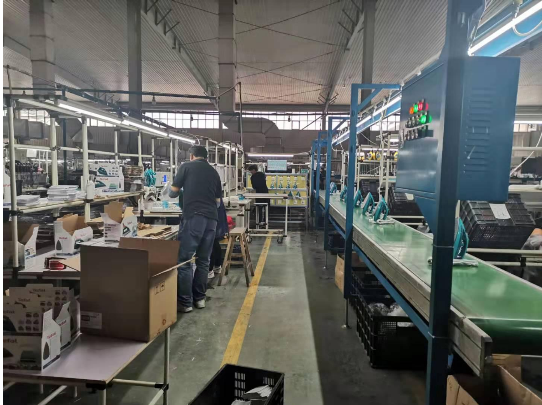
装配一人完结型CELL生产线（组装1×5人、测试1人、包装2人）
