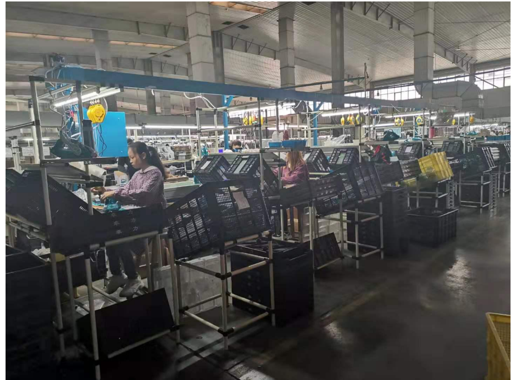
装配一人完结型CELL生产线（组装1×5人、测试1人、包装2人）
