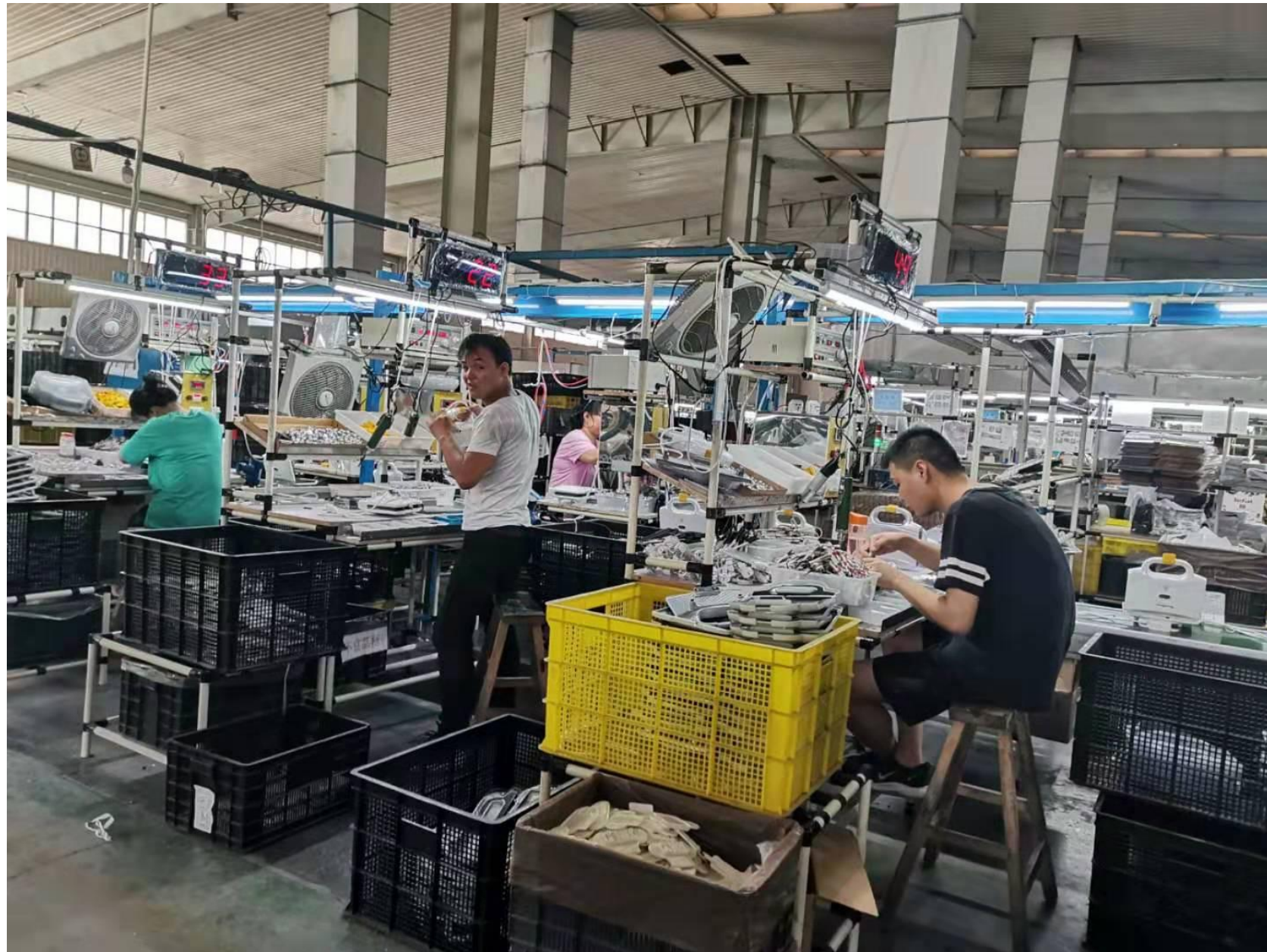
装配一人完结型CELL生产线（组装+烧机+测热高压1×6人）
