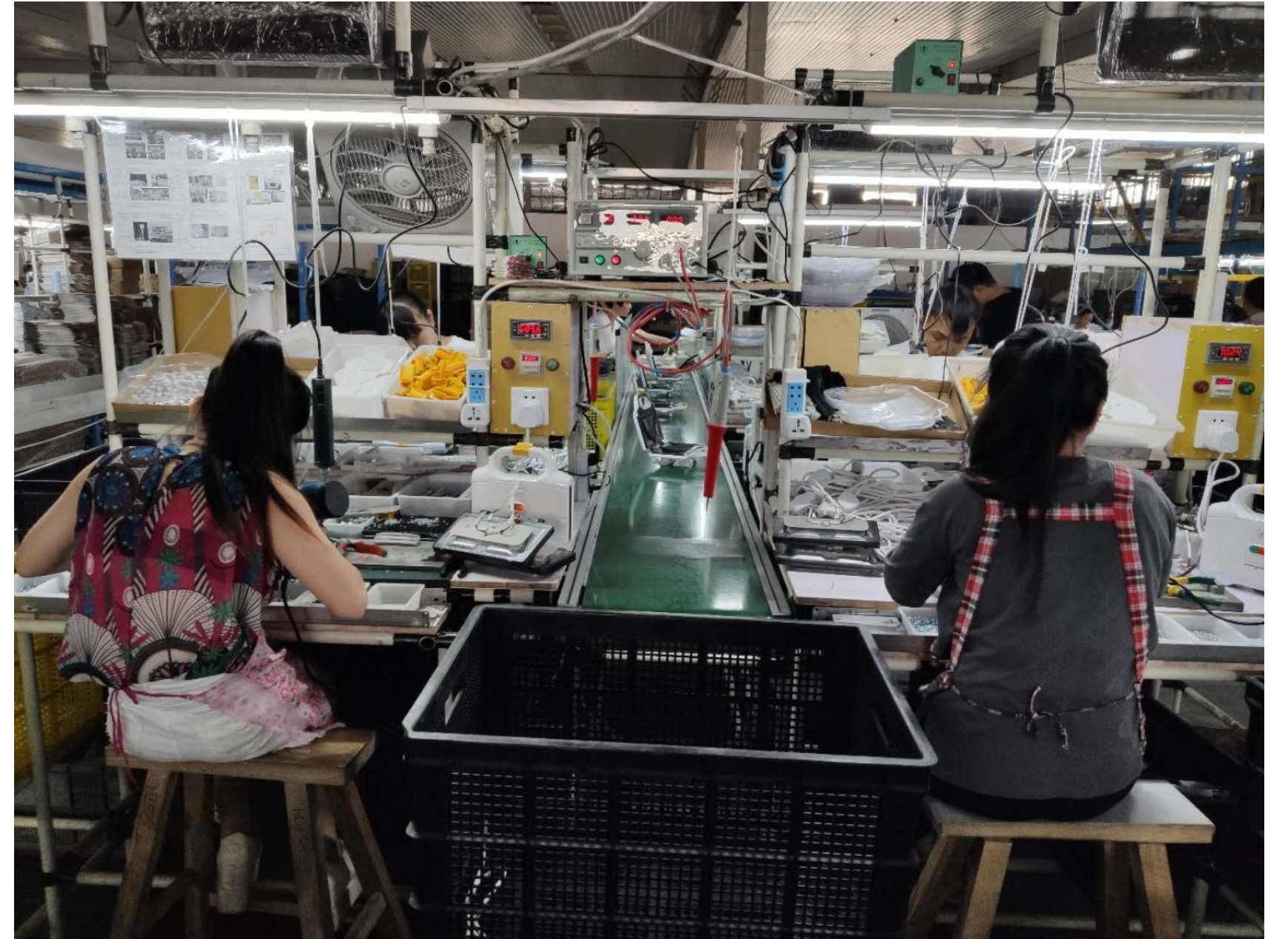
图3 “组装+烧机+测热高压1×6人 “测冷高压及包装2人
